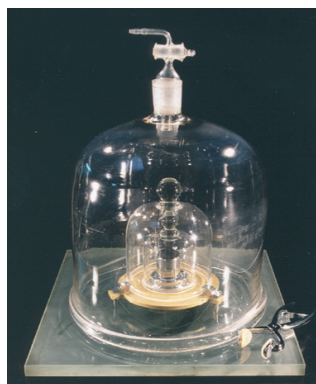
Međunarodna pramjera kilograma (kg) jedini je preostali artefakt koji se upotrebljava za definiranje neke osnovne jedinice SI-a.
